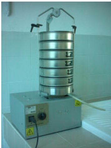
Setacciatore per analisi granulometrica per via umida
