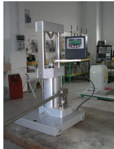
Prova point load su roccia
