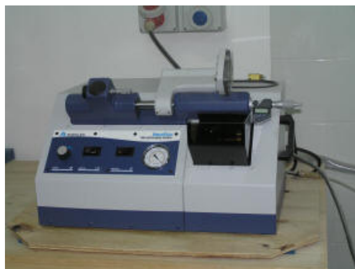
Preparazione di sezioni sottili di roccia
