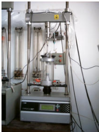
Pressa triassiale con celle per provini da 38,1 mm e da 100 mm di diametro
