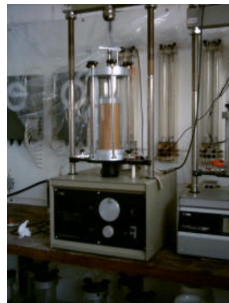
Pressa triassiale con celle per provini da 38,1 mm e da 100 mm di diametro
