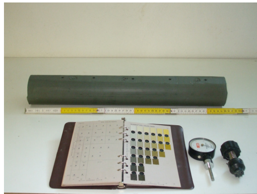
Apertura campione e descrizione mediante prove speditive e carta di Munsell
