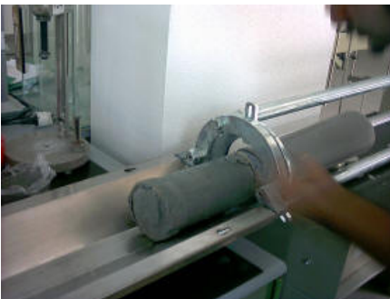
Apertura campione e descrizione mediante prove speditive e carta di Munsell
